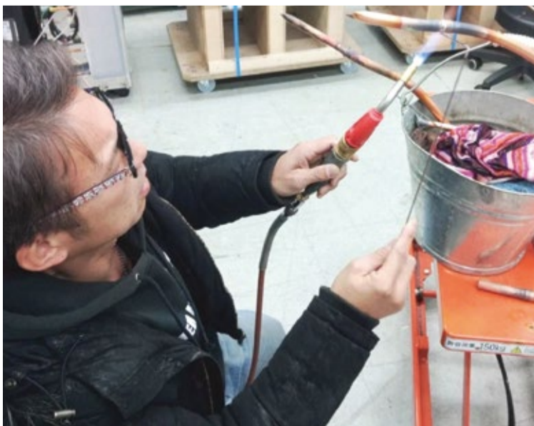
空調機の組立てのための溶接作業
